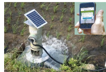
水管理を省力化するための自動給水栓の設置
