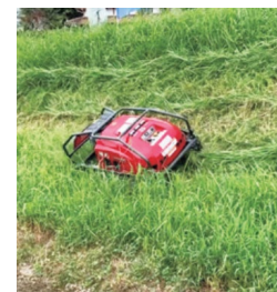
傾斜地の多い中山間地域におけるリモコン草刈機の導入 (法面の緩傾斜化)
