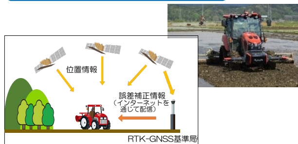
RTK-GNSS基準局の設置により衛星測位データを補正し、自動走行の精度を向上
