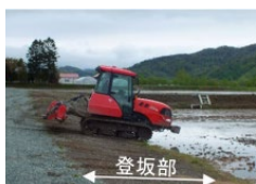
ターン農道を整備することで切り返し等が不要となり、作業効率が向上
